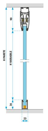
IDEA è un sistema di pareti divisorie, a costruzione con vetro singolo, autoportante, privo di struttura interna, provvisto di giunto verticale in policarbonato che assicura una pulizia formale assoluta, grazie anche alla presenza dei profili di struttura in alluminio estruso fissati esclusivamente sul perimetro della parete.
